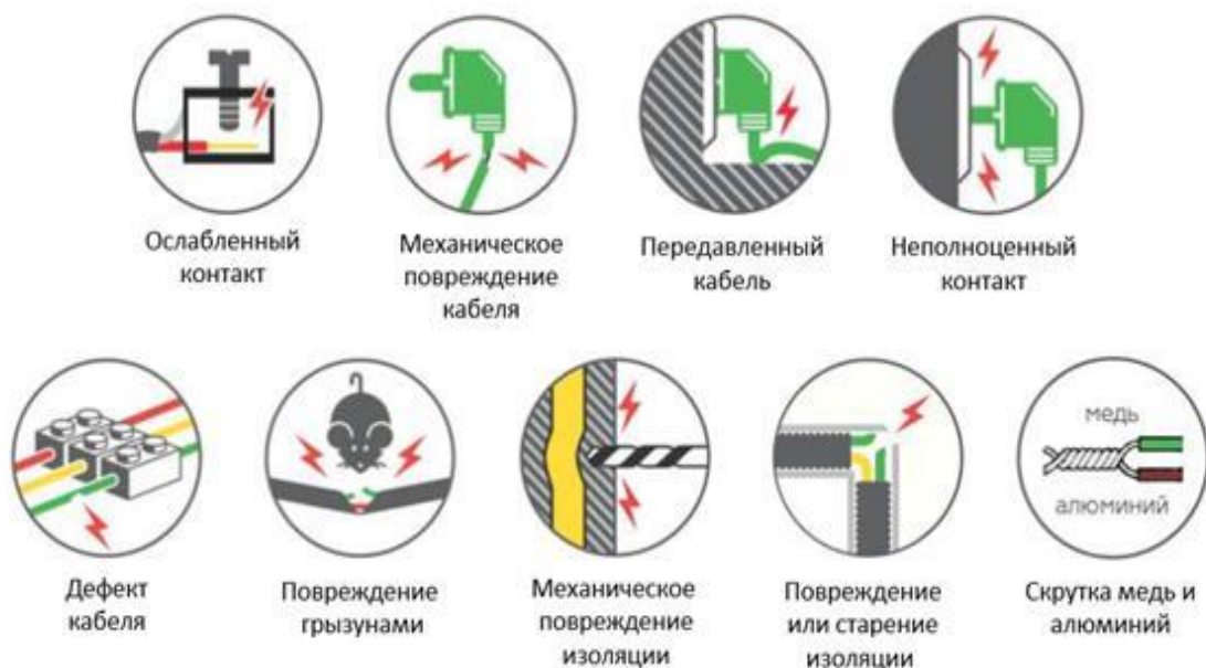
Рисунок 6. Возможные причины искрения в электропроводке
